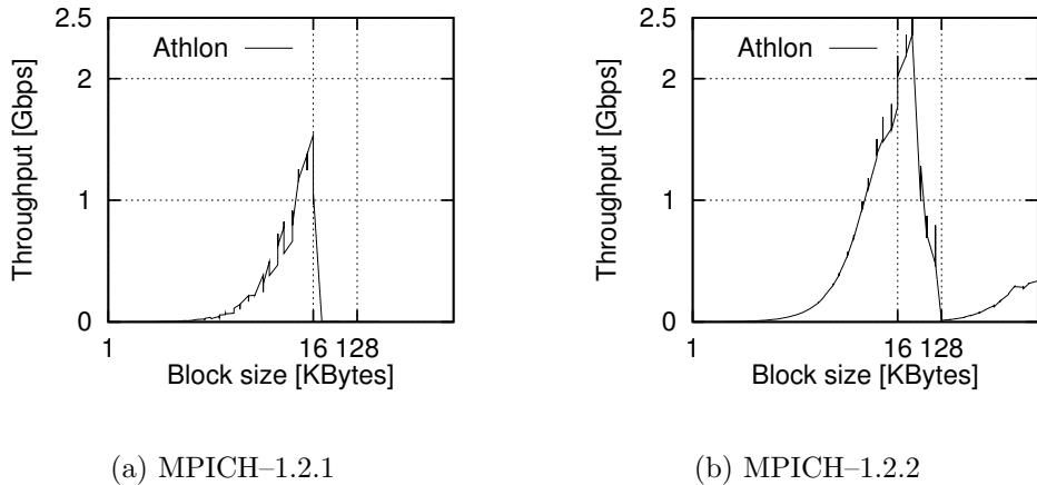
図2 MPICHのバージョンによる通信性能の差
